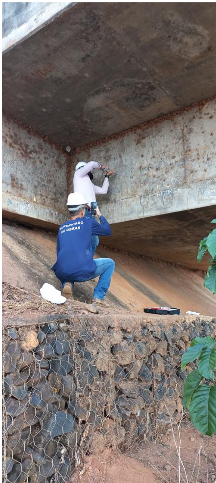
Figura 34 – Ensaio de esclerometria nas longarinas
