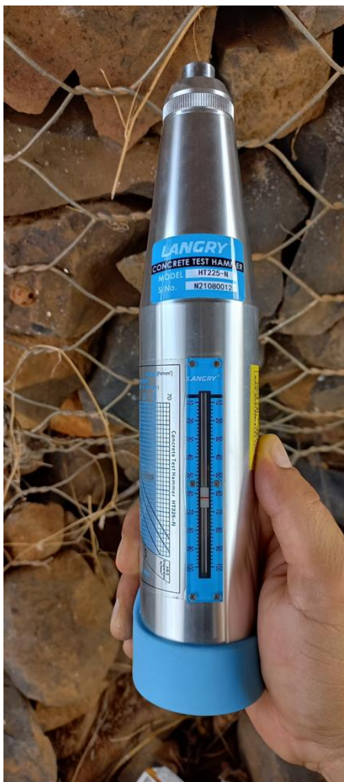
Figura 32 – Esclerômetro - Equipamento utilizado para ensaio de esclerometria
