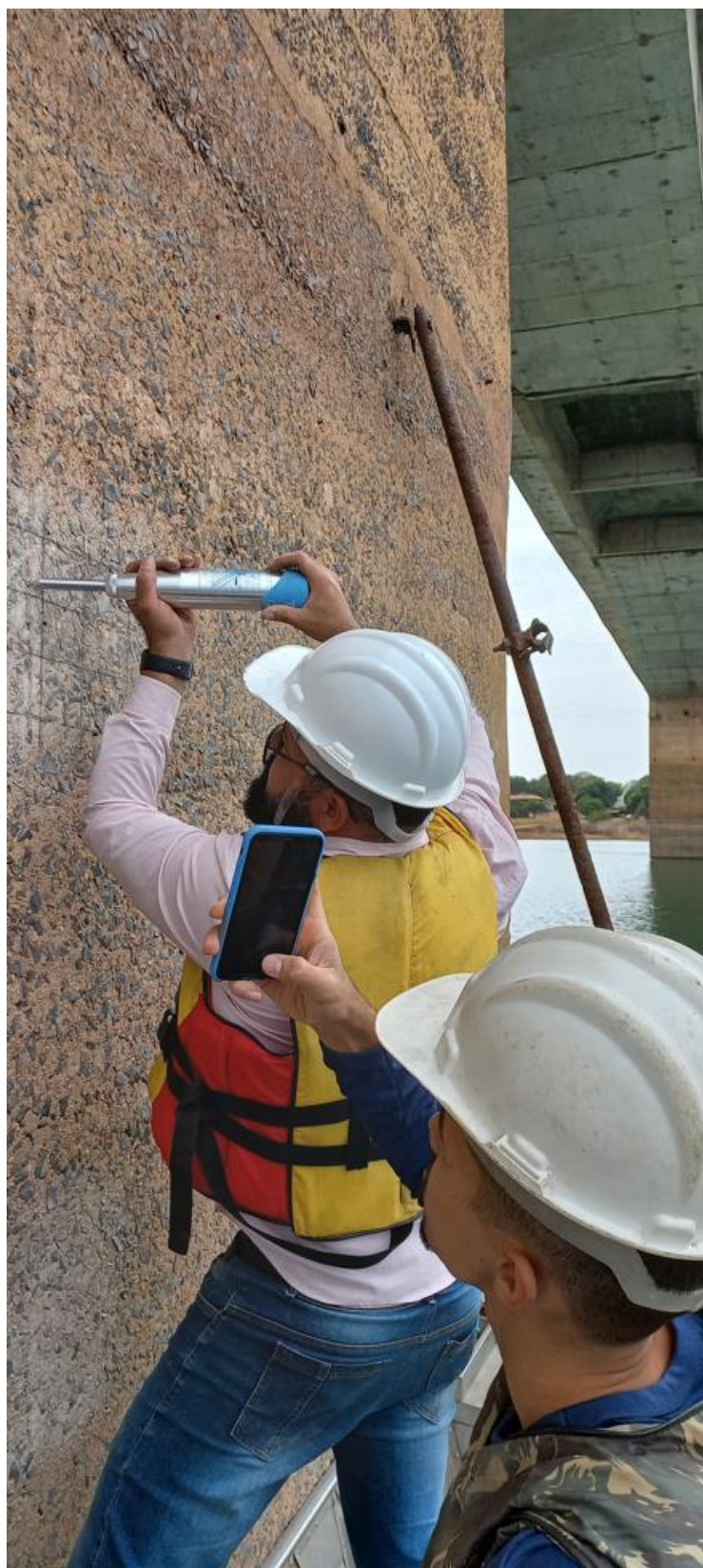
Figura 37 – Ensaio de esclerometria nos pilares parede
