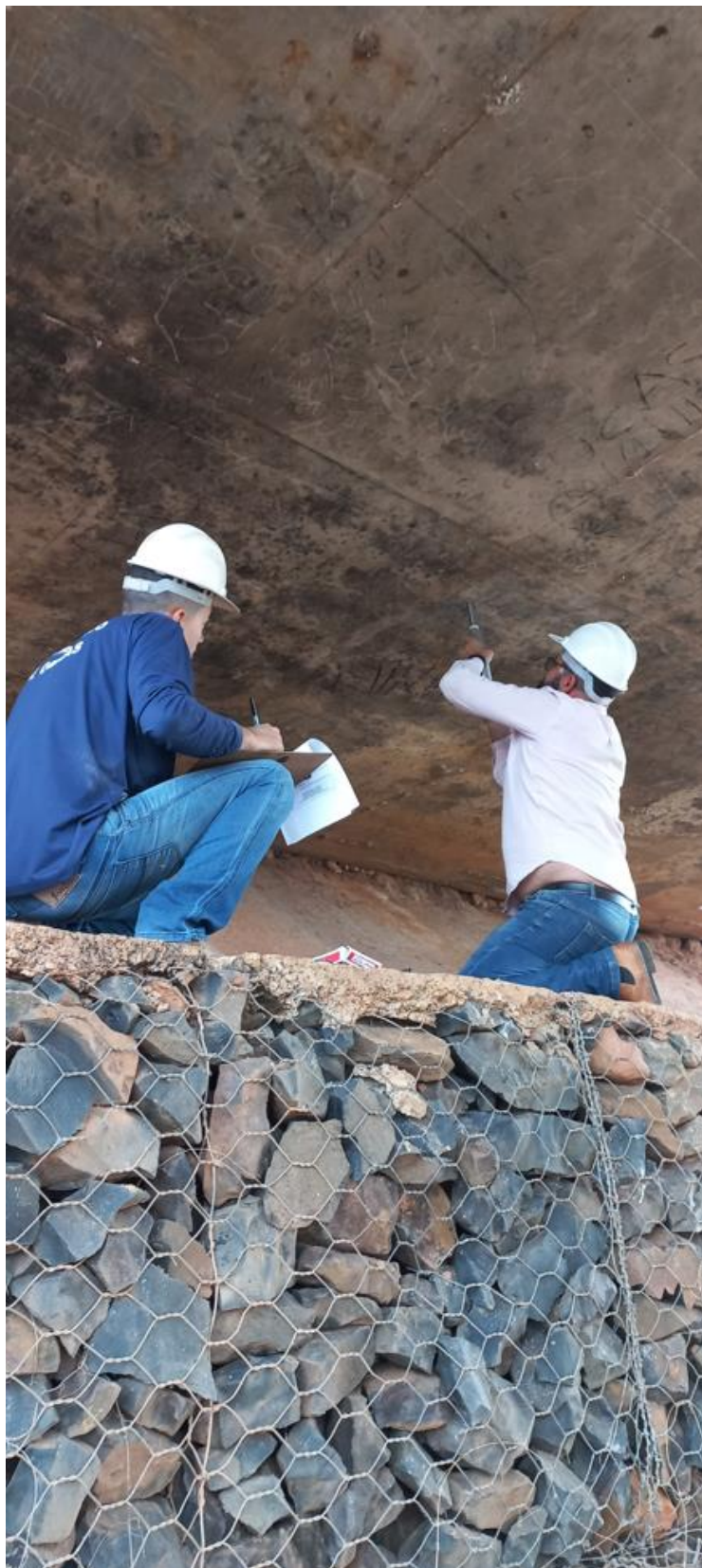
Figura 35 - Ensaio de esclerometria nas lajes inferiores do tabuleiro
