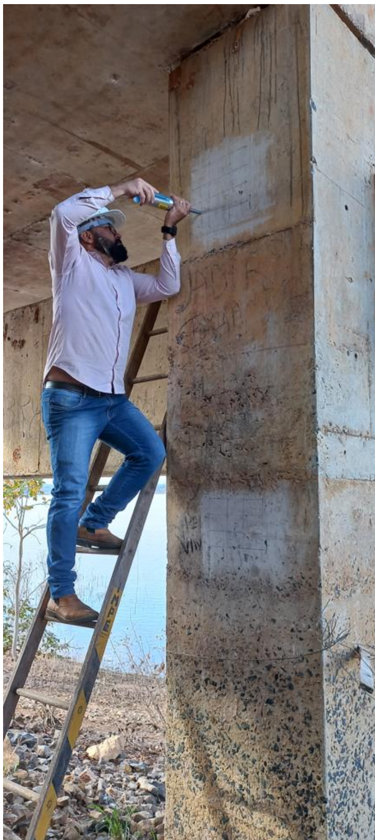
Figura 33 – Ensaio de esclerometria nos pilares
