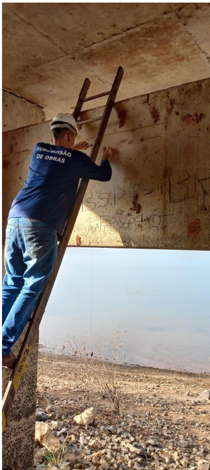
Figura 36 – Ensaio de esclerometria nas travessas
